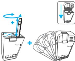
Зніміть ковпачок та помістіть стрічку з параметрами під праву камеру вимірювання. Найтемніша точка стрічки повинна бути видна зверху.
