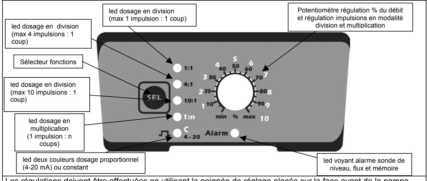
Les régulations doivent être effectuées en utilisant la poignée de réglage placée sur la face avant de la pompe
