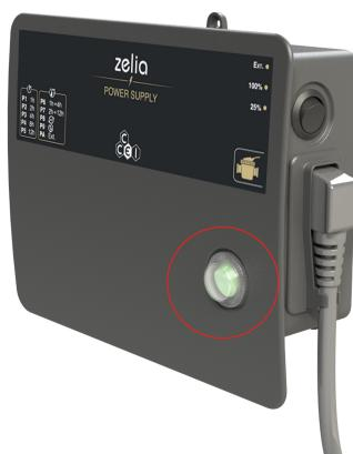
Якщо до блоку підключено автоматичне басейнове покриття, перемикач на боці блоку повинен бути в положенні EXT для виявлення. Можливо переключити перемикач на 100%, щоб перевизначити інформацію про покриття басейну та примусово збільшити номінальне виробництво, або навіть переключити його на 25%, щоб розділити вихід на 4 незалежно від положення бас-нового покриття.
