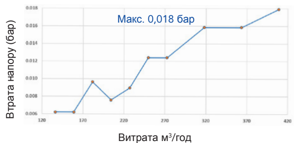
Втрата напору (бар) - d200мм
